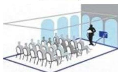
**Стационарная** информационная система с усилителем предназначена для оснащения помещений (зон в помещениях) площадью от 30 до 700 м<sup>2</sup>, монтируется особым образом в пол либо потолок помещения и коммутируется с усилителем, расположенным в непосредственной близости от индукционной петли.
